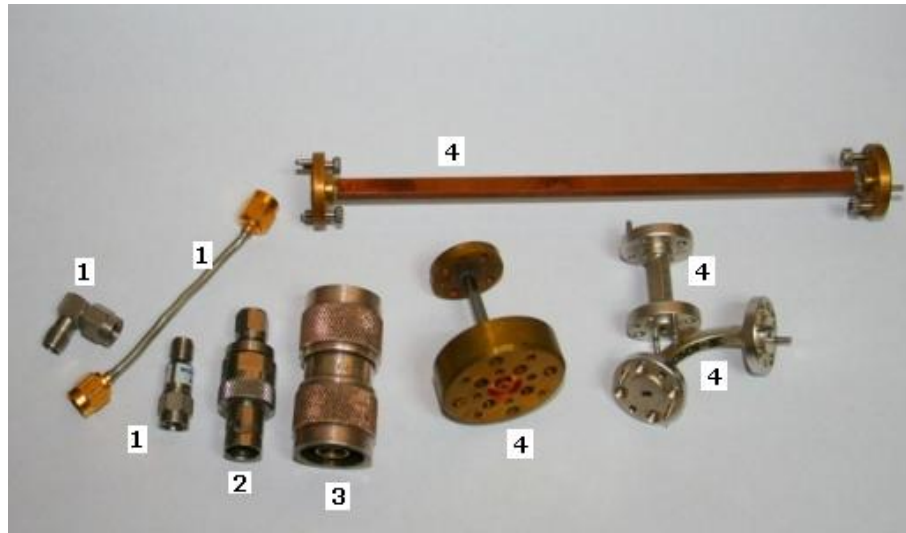
Figura A.1: Conectores utilizados, SMA(1), BNC(2), N(3) y WR10(4)
