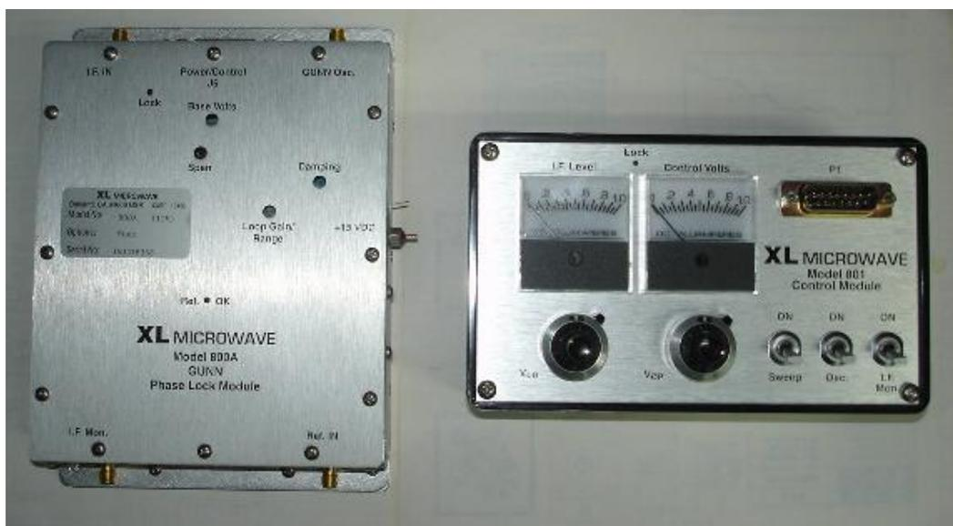
Figura 4.4: Phase Lock Loop para oscilador Gunn de XL Microwave.
