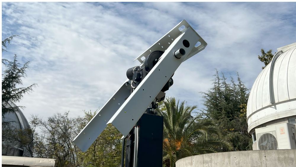
Figura 3.11: Rotor BIG-RAS/HR de la compañía RFHamdesign instalada en el pedestal con la montura de acero.
