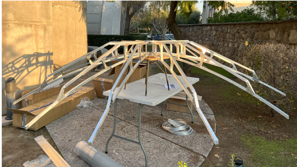
Figura 3.2: Los 12 arcos de aluminio sujetos al centro del reflector parabólico de aproximadamente 15 kilogramos.
