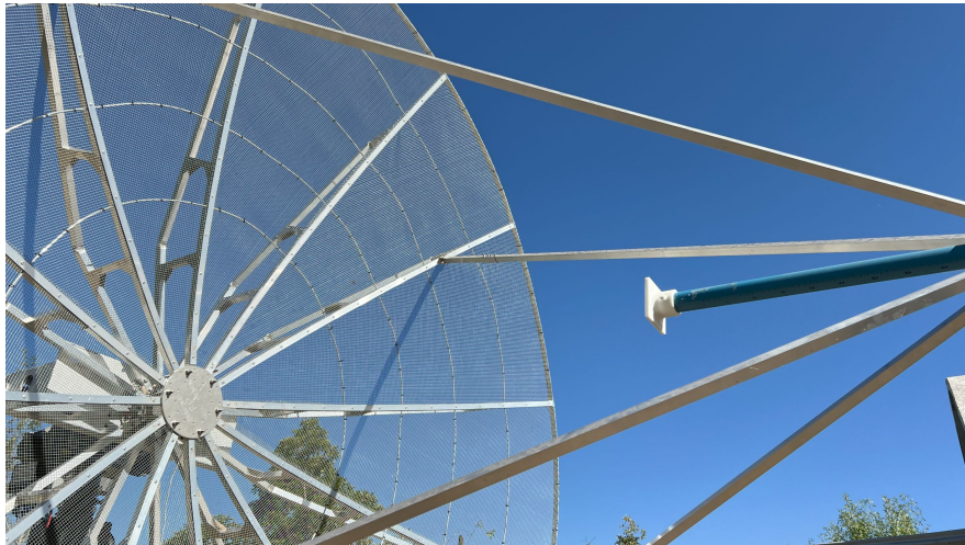
Figura 4.5: Alimentador dipolo de ARTE con tetrápodo instalado a la distancia focal de la parábola a 135 cm.
