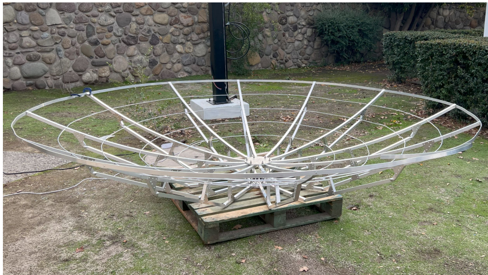
Figura 3.3: Los tubos de aluminio y la cinta de aluminio para la tensión de la malla metálica instalados radialmente en los soportes.
