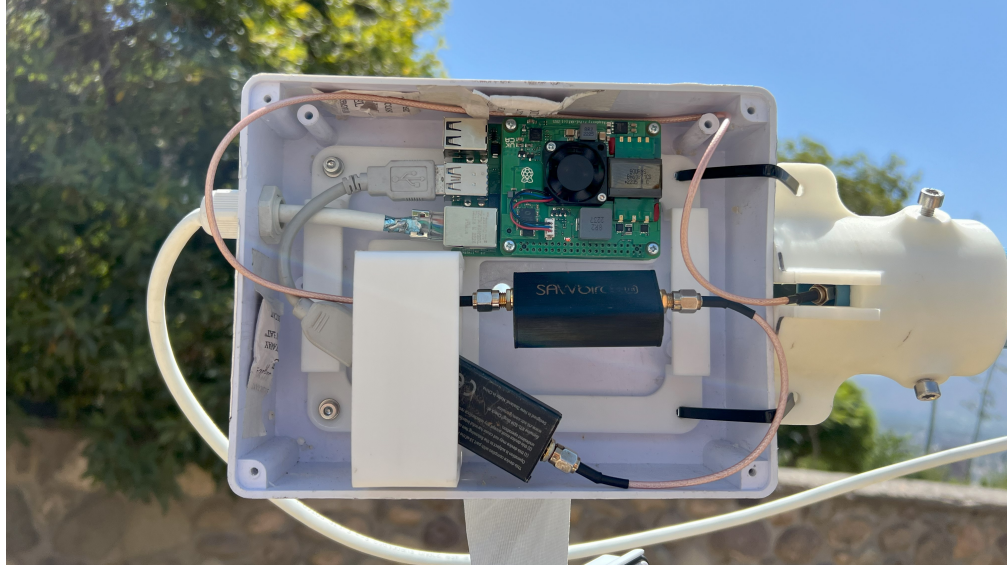
Figura 3.18: RTL-SDR conectada a la cadena de amplificador y una Raspberry PI 4B.
