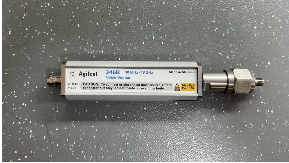
Figura 3.23: Fuente de ruido Agilent 346B.
