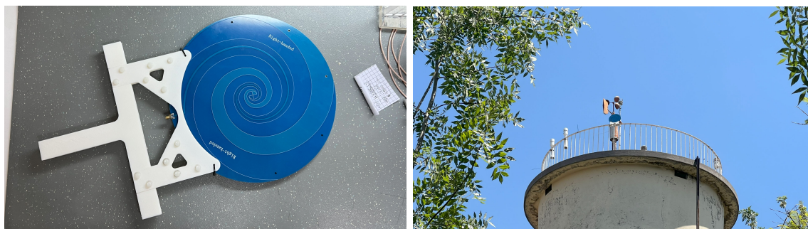
(a) Antena de polarización circular de alto ancho de banda con su soporte para la copa de agua. (b) Antena de la estrella artificial instalada en la copa de agua.
