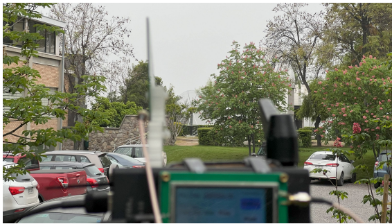
(a) Generador de señales portátil con la antena orientada hacia el reflector.
