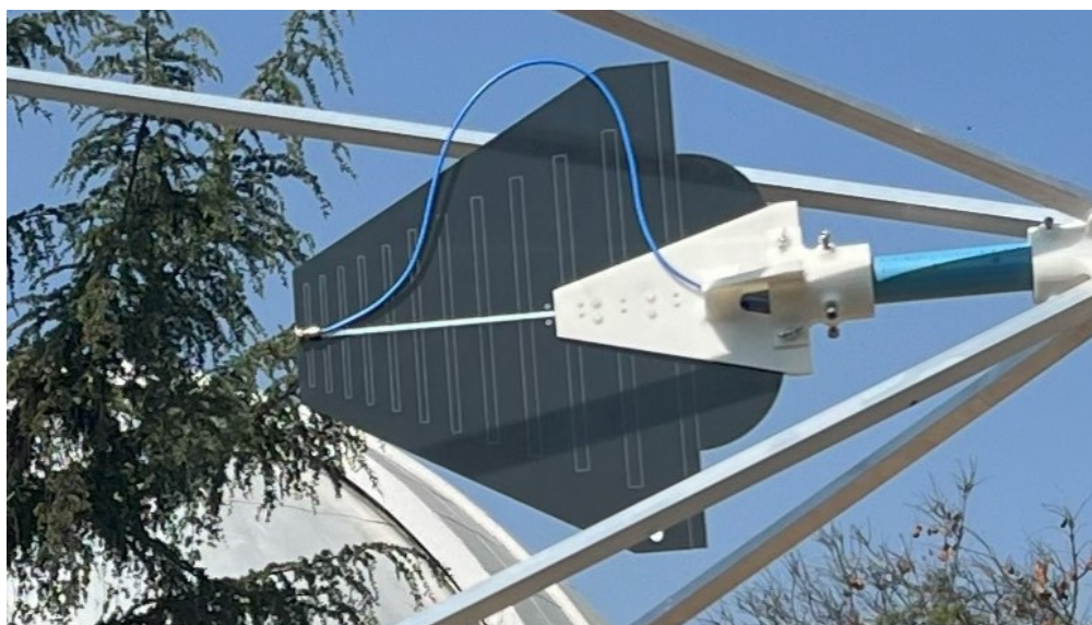
Figura 3.14: Antena LPDA de alto ancho de banda instalada en el telescopio.
