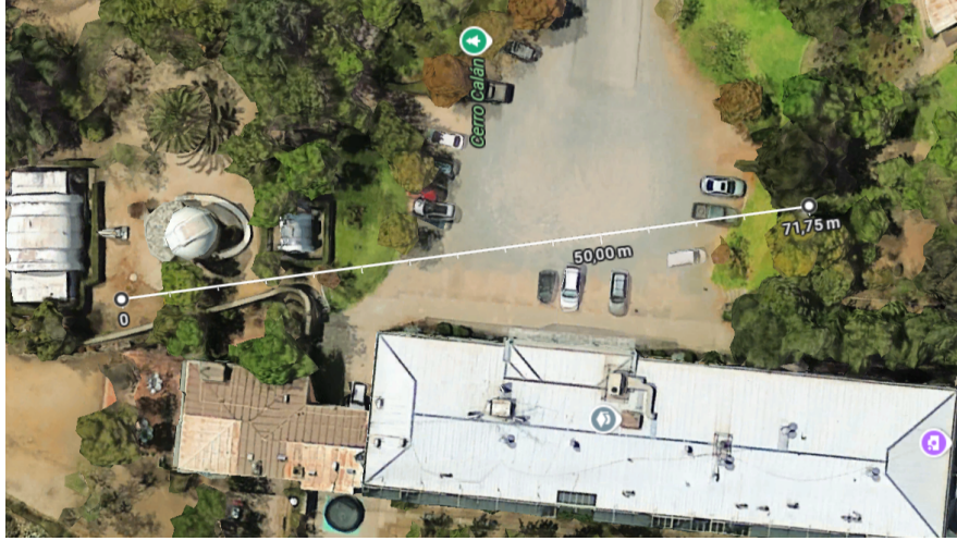
Figura 4.3: Distancia de 70 metros entre el reflector y el generador de señales con elevaciones similares.
