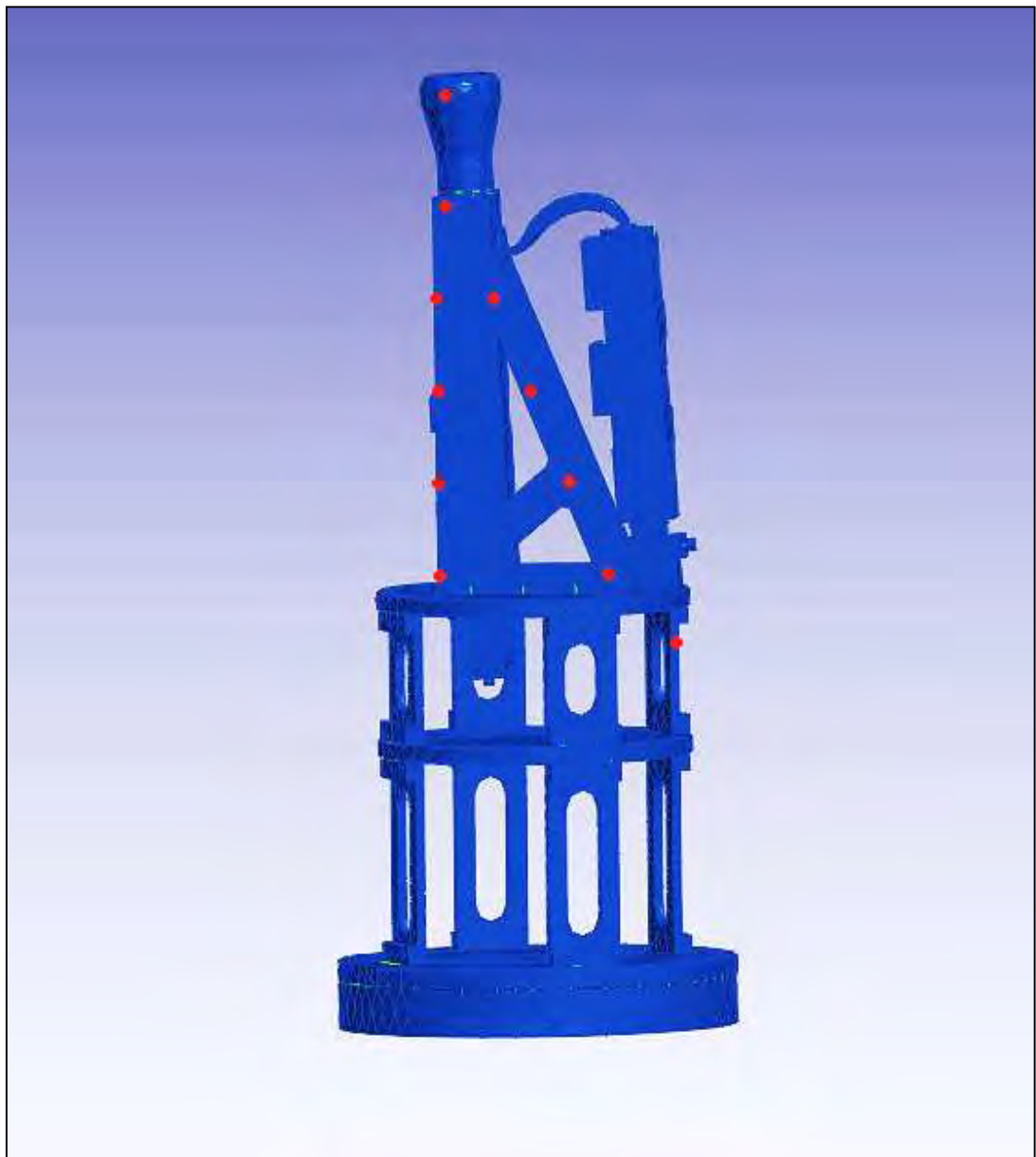
Figura 4-15: 1er Modo de Vibración del Modelo Experimental
