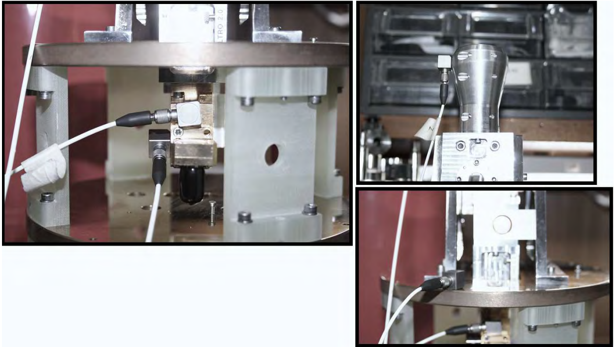
Figura 4-11: Fotografías del montaje de los acelerómetros
