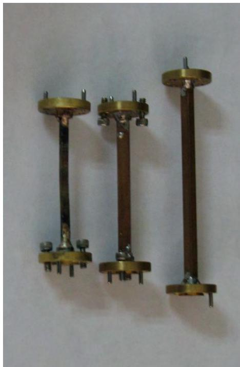
Figura 36: Foto representativa de las guías confeccionadas en el laboratorio mecanico.
