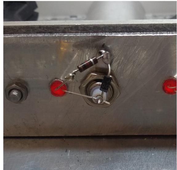
(b) Vista trasera del circuito de polarización.
