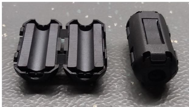
Figura 3.14: Ferritas utilizadas en los cables de polarización.
