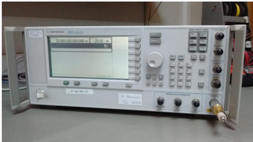
Figura 4.6: Generador de señales Agilent E8257D Analog Signal generator
