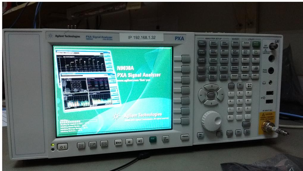
Figura 4.5: Analizador de señales Agilent N9030A PXA Signal analyzer
