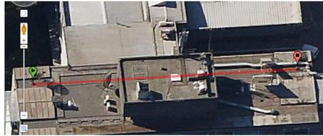
**Figura 4.22:** Medición online de la distancia entre las bases de las antenas.
