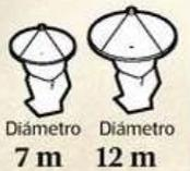
Hay 54 antenas de 12 m y 12 antenas de 7 m. Las últimas sirven para hacer más compacto el arreglo mínimo de antenas (12 antenas chicas y cuatro grandes).
