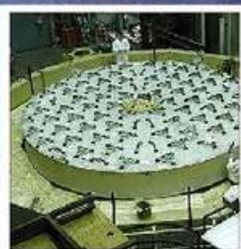
En la foto se ve la construcción del espejo de 6,5 metros del telescopio japonés Tokyo Atacama Observatory (TACO). Observará un amplio campo del cielo y analizará varios objetos a la vez.
