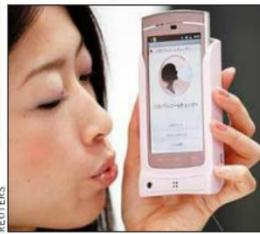
La carcasa "Sensor Jacket" para teléfonos inteligentes mide el mal aliento y el hálito alcohólico. Los resultados del análisis se muestran en la pantalla del celular.
