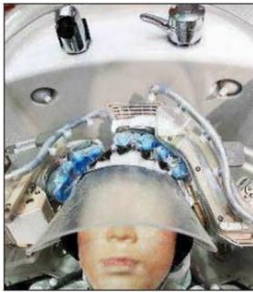
Este robot de Panasonic puede lavar y secar el pelo del usuario en forma automática usando sus dedos tras escanear la cabeza. Especial para discapacitados.
