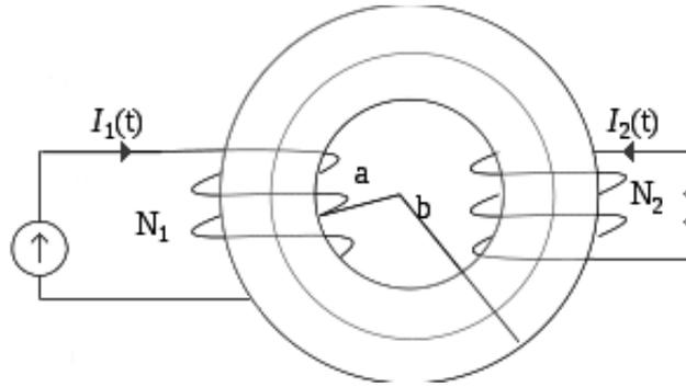
1. (+0.5pt) Explique porque el núcleo 'conduce' el campo magnético, i.e. explique porque es aproximadamente constante en azimuth.
