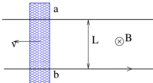
Los e- en la barra (azul) sufren  $\vec{F} = q\vec{v} \times \vec{B}$  en dirección  $b \rightarrow a$ . Cuando los e- llegan a  $a$ , no se acumulan ahí mismo, sino que son conducidos de  $a$  hacia  $b$  completando un circuito con corriente  $I$ .
