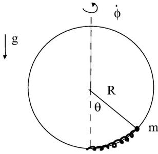
Una masa puntual  $m$  puede deslizar sin roce sobre un anillo de radio  $R$  colocado en posición vertical en el campo gravitacional terrestre. El anillo gira con velocidad angular constante sobre un eje vertical que pasa por su centro y la masa  $m$  está unida a un resorte de constante  $k$  fijo al otro extremo en el punto más bajo del anillo. El resorte tiene largo natural  $R\theta_0$ .
