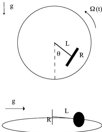
Un disco de radio  $R$  y masa  $M$  se encuentra apoyado sobre una superficie vertical que gira con velocidad angular  $\Omega(t)$  no constante. El contacto es tal que el disco rueda sobre su eje, sin resbalar sobre la superficie. Además, el disco se encuentra sujeto al punto  $O$  por una vara sin masa de largo  $L$ .
