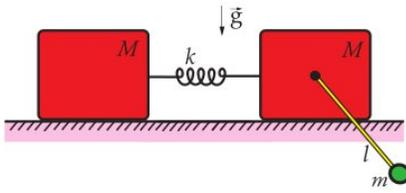
Considere un sistema compuesto por dos bloques de masa  $M$ , conectados entre si por un resorte de constante elástica  $k$ , que deslizan sobre una superficie horizontal sin roce. Sobre uno de los bloques cuelga, desde su centro, un péndulo de largo  $l$  y masa  $m$ , como se ilustra en la Figura.
